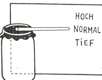
Wir zerschneiden den Luftballon so, dass wir ein Stück Gummi erhalten, mit dem man die Öffnung des Einmachglases gut überspannen kann. Dann befestigen wir das Gummistück auf dem Glas mit Hilfe eines Gummiringes. Das eine Ende des Strohhalses wird nun mit Hilfe von Klebstoff in der
