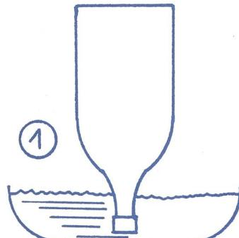
Durch das warme Wasser wird die Flasche und somit auch die Luft in der Flasche erwärmt. Die Luft dehnt sich aus, findet aber in der Flasche nicht mehr genügend Platz. Dadurch wird ein Teil der Luft aus der Flasche verdrängt und blubbert als Luftblasen durch das Was-
