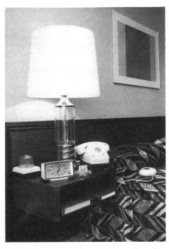
Technische Hilfsmittel von links nach rechts: Blitzrundleuchte, Blitzwecker mit steckbarem Kissenvibrator (ganz rechts im Bild), Telefonapparat mit angebautem Visotel und Hörer mit regulierbarer Lautstärke.
