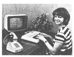
Wir möchten in diesem Bericht die Speichermöglichkeiten des COMBIPHON genauer betrachten. Die Grundausführung besitzt einen Speicher für über 900 Zeichen. Dieser ganze Text ist auf dem Bildschirm sichtbar, immer deutlich in zwei Blöcke unterteilt. Auf der einen Seite erscheint der eigene Text, auf der anderen der des Gesprächspartners. Sie können auf dem COMBIPHON-Bildschirm lesen wie in einem Buch.
