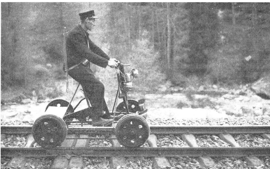
Eine Draisine erleichtert dem Streckenwärter zum Teil die Kontrollgänge.
