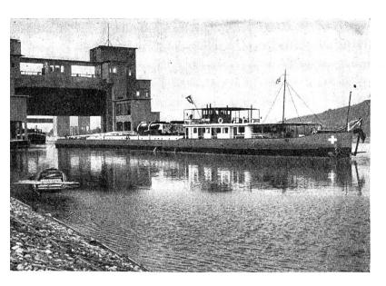
Schlepper mit einer Zugkraft von 4000 PS beim Verlassen der Schleuse von Kembs
