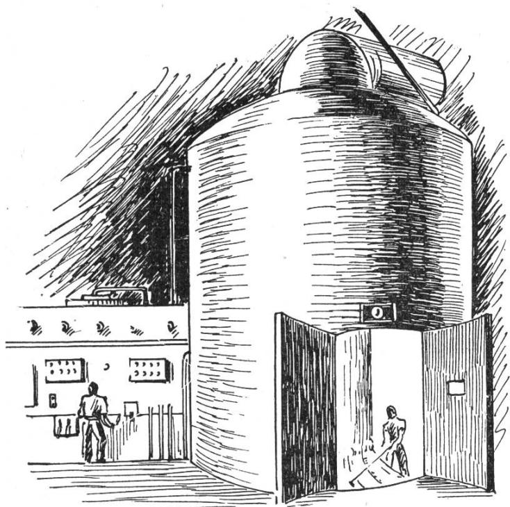
füllt sie 40 000 Pakete mit luftigen Seifenflocken — ohne menschliche Hilfe — und klebt sie zu. Die Tagesleistung eines Sprühturmes: 20 bis 30 Tonnen (20 000 bis 30 000 Kilo!) flüssige Seife «verpulvern». (Auf dem einen Bild sieht ihr einen Sprühturm, auf dem andern eine automatische Abfüll- und Paketiermaschine.)
