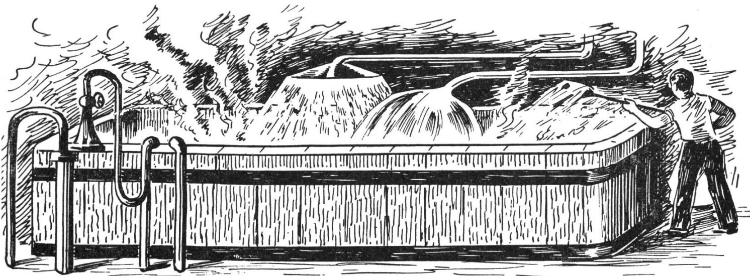
Die Öle und Fette bestehen aus Fettsäure und Glyzerin. Das Glyzerin ist unbrauchbar für Seife. Zusammen mit Wasser werden die Öle und Fette auf zirka 230 Grad erhitzt: das schwere Glyzerin sinkt im Dampfkessel auf den Boden, die Fettsäure schwimmt obenauf. So kann man die Fettsäure leicht weg-
