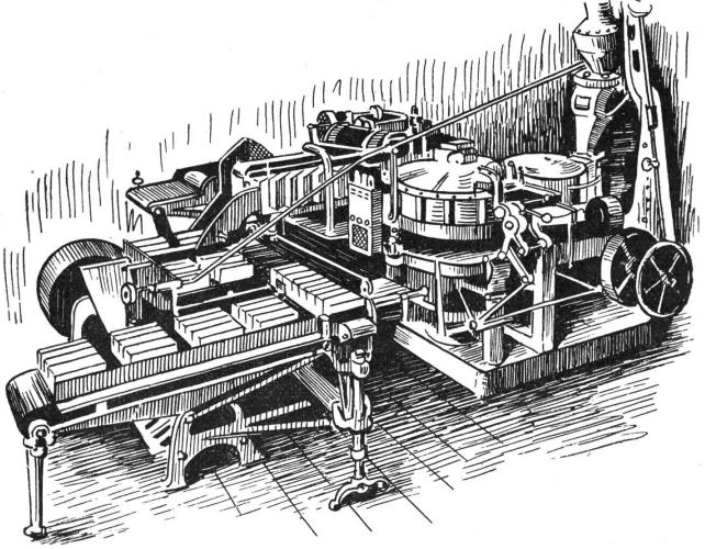
die Farben in der Seifenmasse gleichmäßig verteilt. Die Seife kommt als lange «Nudeln» aus dem Walzwerk. Diese «Nudeln» fahren auf einem Transportband in die Strangpresse. Diese preßt die Nudeln zu Seifenstangen. Lange Stangen
