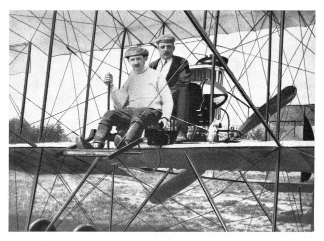
Das Bild zeigt den Piloten Henry Kunkler auf seinem Farman-Doppeldecker 1913 in Dübendorf. Der Pilot sitzt mit seinem Kameraden in einem Spinngewebe von Metalldrähten. Man hat wenig Vertrauen zu einer solchen Maschine. Es braucht Mut, mit diesem gebrechlichen Fahrzeug in die Lüfte zu steigen. Die Flügel waren aus leichtem Stoff. Stärker und schwerer durfte man damals die Flugzeuge nicht bauen. Denn die damaligen Motoren waren zu schwach für schwere Flugzeuge.
