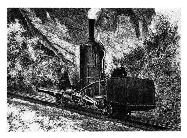
Die erste Rigibahn-Lokomotive mit senkrechtem Dampfkessel.
