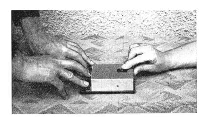
Am Tastleseapparat drückt der Sprecher (links) auf sechs Tasten. Auf der andern Seite hüpfen die Warzenbuchstaben hervor. Der Taubblinde (rechts) fühlt sie ab, hängt sie zusammen zu Wörtern und Sätzen. Dann kehrt er die Maschine um, drückt selber auf die Tasten, und der
