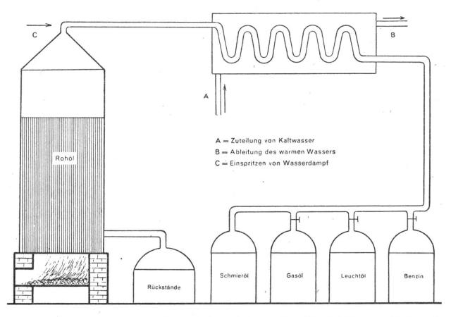
Bild 4. Einfache Darstellung der Rohölverarbeitung. Das Öl wird bis zum Siedepunkt gekocht. Der Reihe nach verdampfen Benzin, Leuchtöl, Gasöl und Schmieröl. Die Öldämpfe kühlen sich in einem Wasserbehälter ab und verflüssigen sich wieder.
