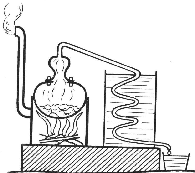
sind, dann verdampft der Alkohol. Der Alkoholdampf steigt in den Deckel empor. Er strömt durch das Rohr. Da, in der Rohrschlange, da wird der Dampf abgekühlt. Er kondensiert, er wird wieder flüssig. Unten kommt aus der Rohrschlange flüssiger Alkohol (Schnaps, Sprit) heraus. Wenn der Brenner zu stark heizen würde, dann würde auch das Wasser in den Tretern verdampfen, dann würde der Sprit verwässert.
