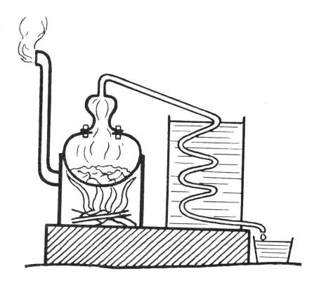
sind, dann verdampft der Alkohol. Der Alkoholdampf steigt in den Deckel empor. Er strömt durch das Rohr. Da, in der Rohrschlange, da wird der Dampf abgekühlt. Er kondensiert, er wird wieder flüssig. Unten kommt aus der Rohrschlange flüssiger Alkohol (Schnaps, Sprit) heraus. Wenn der Brenner zu stark heizen würde, dann würde auch das Wasser in den Trestern verdampfen, dann würde der Sprit verwässert.
