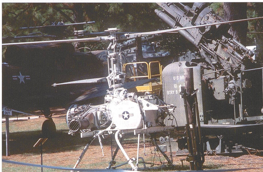
Ein «remote control» QH-50 Helikopterdrohne der US Navy, eingesetzt für die U-Boot Jagd in den 60er Jahren.
