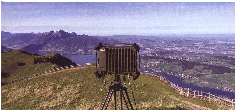
Das Richtfunksystem MODULOS RFE-I mit integrierten Antennen von Thales in der Schweiz.
