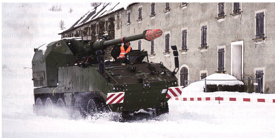
Das AGM Artillery Gun Module (155 mm) mit der Piranha-Trägerplattform.
