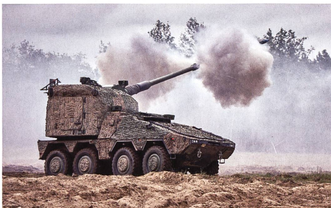
RCH 155 (Remote Controlled Howitzer 155 mm) ist ein selbstfahrendes Artilleriegeschütz auf Rad im Kaliber 155 mm des deutsch-französischen Rüstungsunternehmens KNDS.
