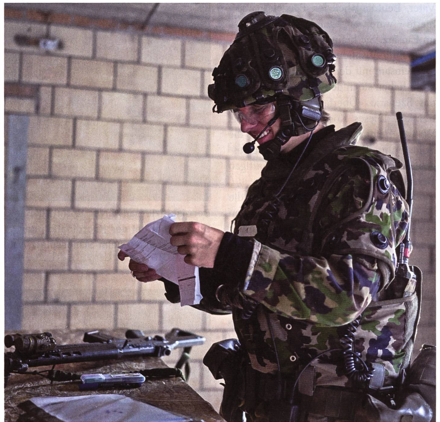
Das Simulationssystem mit Sensoren am Körper (Kopf, Oberkörper und Oberschenkel) und an der Waffe.
