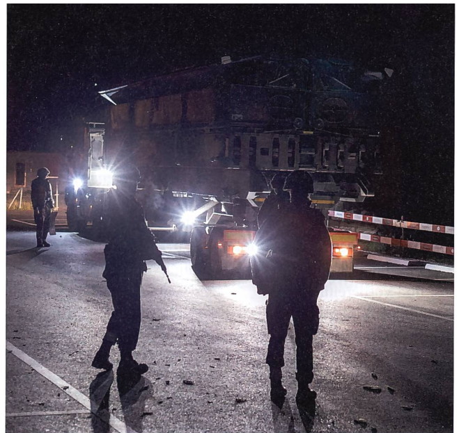
Einwassern der Module der Schwimmbrücke 95 unter Sicherstellung des Eigenschutzes.
