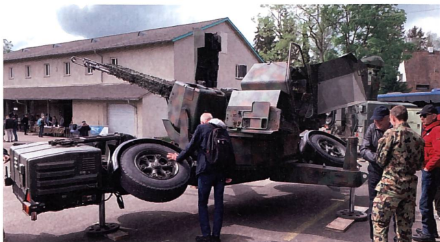
Die 35mm Kanone der mittleren Fliegerabwehr.
