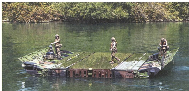
Sobald das Brückenteil im Wasser ist, manövrieren es die Soldaten zur Seite.
