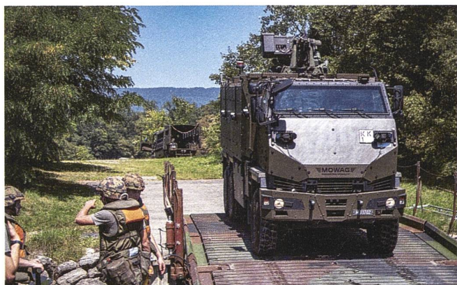
Die Schwimmbrücke hält einer Last von bis zu 70 Tonnen stand.
