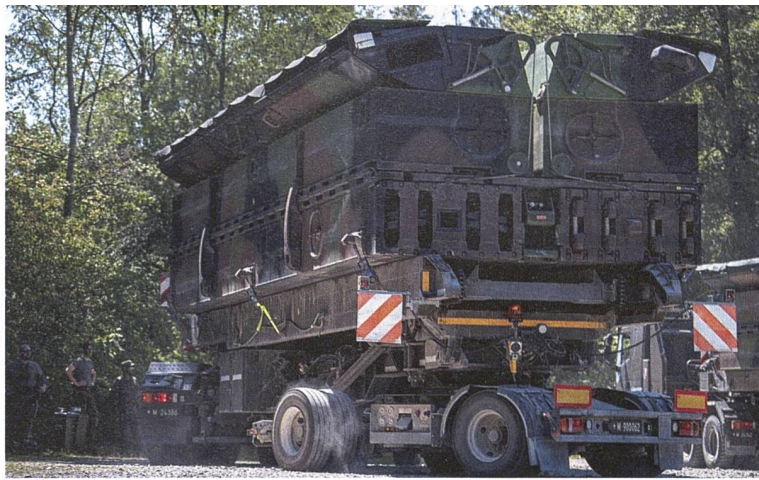
Brückenteile der Pontoniere werden mit Lastwagen zum Zielort transportiert.
