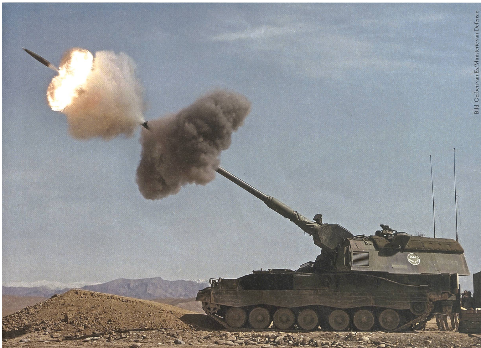
Die Panzerhaubitze 2000 verwendet ebenfalls das 155mm-Vielzugrohr L/52.
