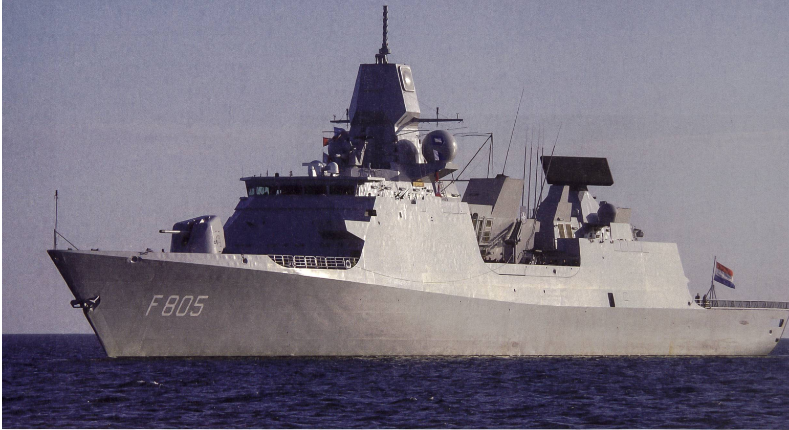
Die moderne Raketenfregatte «Evertsen» der «De Zeven Provinciën»-Klasse. Das Luftabwehr-Schiff verdrängt über 6000 Tonnen und wurde in Vlissingen gebaut.
