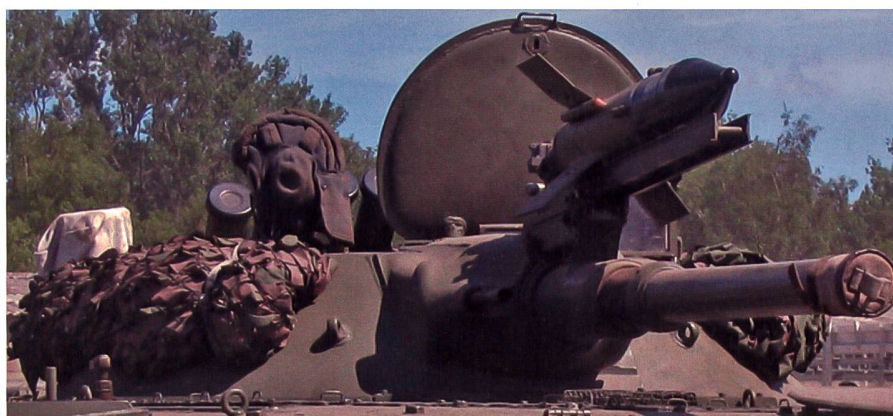
Kanone des BMP 1. Im Gegensatz zum Marder hat der BMP keine Maschinenkanone.
