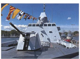
Das Vorschiff der modernen französischen Raketenfregatte «Auvergne» (Typ FREMM) mit einem 76 mm Geschütz und Startkanistern für Schiff-Luft und Schiff-Schiff-Raketen im Hafen von Kiel.
