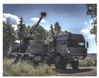
Die neuen Artilleriesysteme sollen radgestützt operieren. Hier im Bild: BAE Systems Bofors AB, Schweden, Archer 8×8 mobile howitzer.
