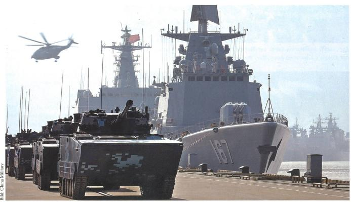
Das PLANMC verfügt u.a. über gepanzerte Schwimmpanzer des Typs ZBD-05.
