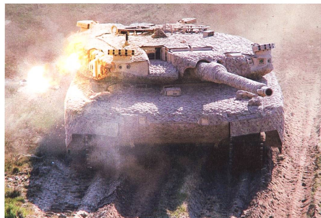
Demonstration des StrikeShield Aktivschutzsystems auf einem Leopard 2.
