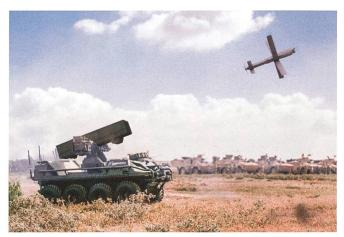
HERO-120 Loitering Munition: Diese Kamikaze-Drohne, von denen vier Stück mitgeführt werden, kann sowohl als Sensor als auch als Effektor eingesetzt werden.
