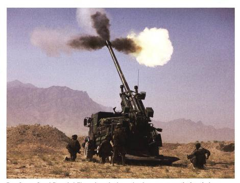
Das Caear-Geschütz wird über einen Lademechanismus automatisch geladen. Damit können sechs bis acht Schuss pro Minute abgefeuert werden.
