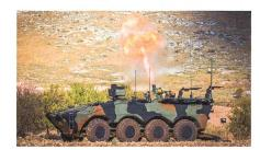
Minenwerferversion des VMB Freccia.
