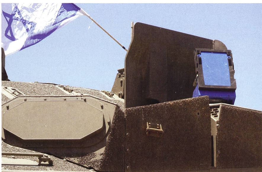
Das Trophy-System auf einem israelischen Kampfpanzer. Auf diesem Bild sichtbar: Eine blaue Patrone wurde als Übungsmunition in den Trophy-Werfer geladen.
