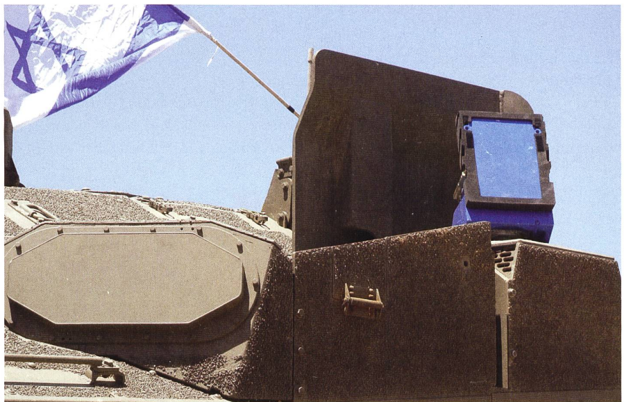
Das Trophy-System auf einem israelischen Kampfpanzer. Auf diesem Bild sichtbar: Eine blaue Patrone wurde als Übungsmunition in den Trophy-Werfer geladen.
