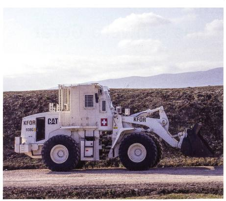
Genie-Fahrzeuge im Einsatz müssen über einen besonderen Schutz verfügen. Dieser Bagger ist gegen Kleinfeuerwaffen sowie Spreng- und Brandvorrichtung geschützt.
