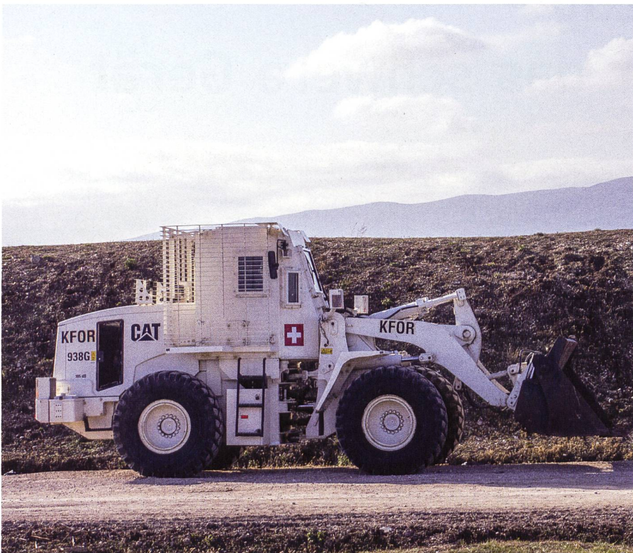
Genie-Fahrzeuge im Einsatz müssen über einen besonderen Schutz verfügen. Dieser Bagger ist gegen Kleinfeuerwaffen sowie Spreng- und Brandvorrichtung geschützt.
