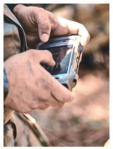
Das 4,7-Zoll-Display mit einer Helligkeit von 550 cd/m<sup>2</sup> ist entspiegelt und kann mit Handschuhen bedient werden.
