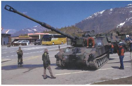
Die neueste kampfwertgesteigerte Version der Pz Hb M-109 auf dem Simplon. Das Rohr L47 weist jetzt eine Länge von 7,35 m (Rohrlänge des L39 Geschützes 6,20 m) auf.
