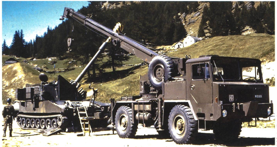
Die damaligen Dienstbatterien (heute Logistikbatterien) verfügten über eigene Faun-Kranfahrzeuge, die beispielsweise auch den Wechsel der General Motors V8 Dieselmotoren (405 PS) der Pz Hb durch die eigenen Mechaniker erlaubten.
