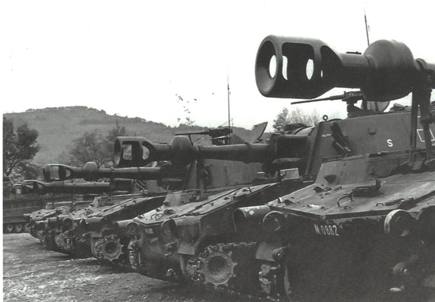
Erste Versuche der Hb Bttr III/10 im WK 1967 mit M-109 in der Region Thun. Hier sind im Gürbegrüen vorne die zwei US-Versionen (M-109U) und hinten die drei deutschen Versionen (M-109G) mit der Rohrlänge L23 zu erkennen.
