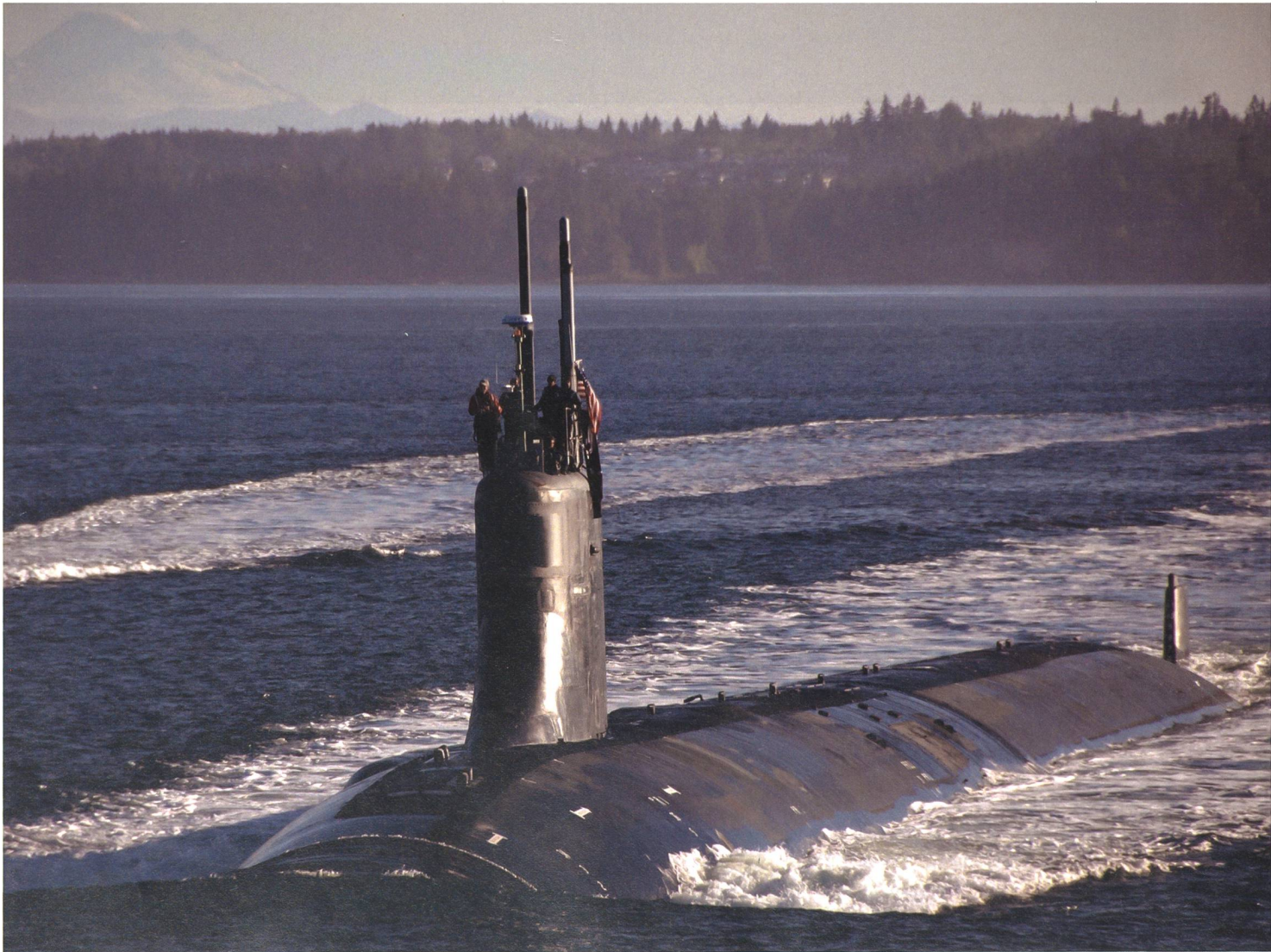
Das Spezial-Uboot USS «Jimmy Carter», ein Jagd-Uboot der Seawolf-Klasse ist für spezielle Operationen, u.a. mit Spezial- kräften, umgebaut und verlängert worden. Man geht davon aus, dass es auch für Einsätze gegen Unterwasserinfrastrukturen eingesetzt wird.
