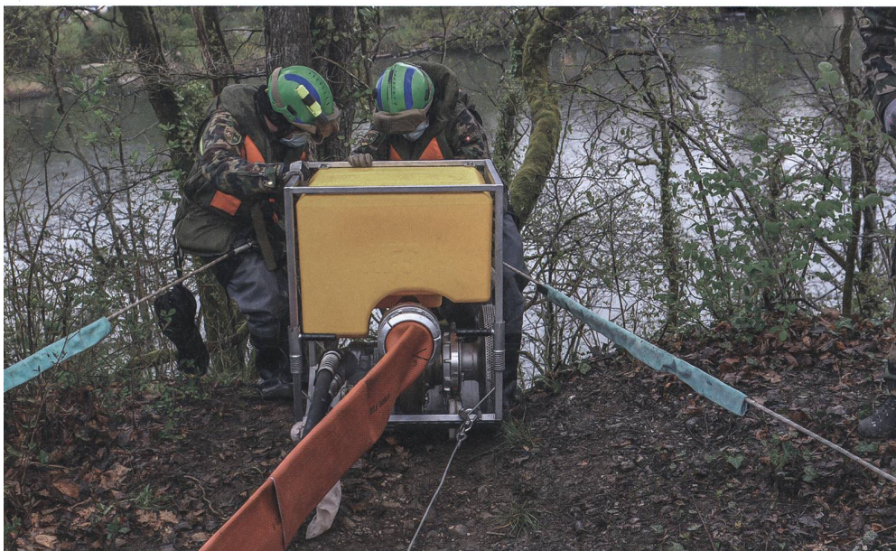
Ebenfalls zu den Fähigkeiten des Rttg Bat 2 gehört der Wassertransport. Dabei wird mit einer Tauchpumpe (im Bild) Wasser von einer Quelle bezogen und dann zu der benötigten Stelle gepumpt.
