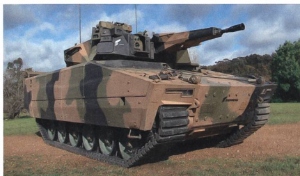
Rheinmetall Lynx KF41 im Versuch mit Verbundgummikette.
