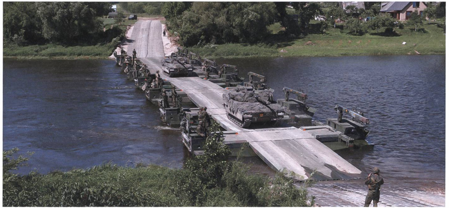
System M3: Als Brücke oder mehrteilige Fähre einsetzbar.
