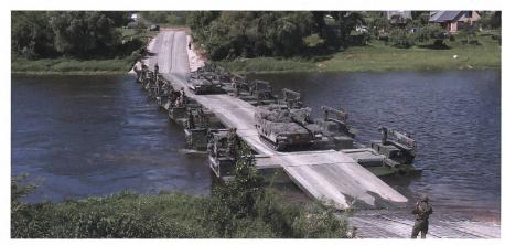
System M3: Als Brücke oder mehrteilige Fähre einsetzbar.
