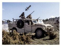
Testabschuss einer MMP von einem Patrouillenfahrzeug Sabre.
