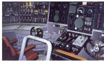
Die Steuerkonsole auf dem ballistischen Lenkwaffenuboot USS «Maine» (SSBN-741), dem drittneuesten «Boomer» der «Ohio»-Klasse. Das Boot wurde 1995 in Dienst gestellt. Links ist der Arbeitsplatz des Tauch-Rudergängers (Tiefensteuerung – planesman), rechts jener des Rudergängers Seitensteuerung – helmsman.
