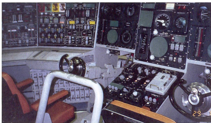
Die Steuerkonsole auf dem ballistischen Lenk Waffenuboot USS «Maine» (SSBN-741), dem drittnuesten «Boomer» der «Ohio»-Klasse. Das Boot wurde 1995 in Dienst gestellt. Links ist der Arbeitsplatz des Tauch-Rudergängers (Tiefensteuerung – planesman), rechts jener des Rudergängers Seitensteuerung – helmsman.
