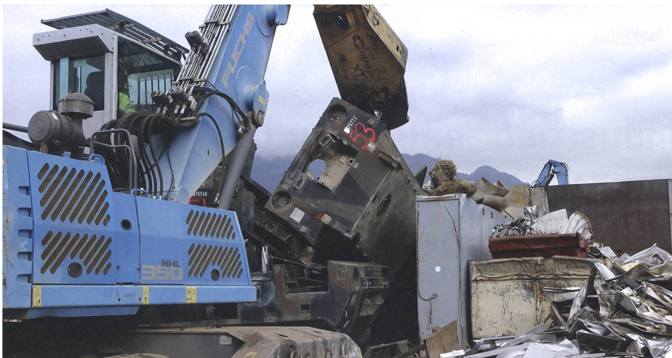
Die Fahrzeuge wurden zerlegt und die Materialien, wie zum Beispiel Aluminium, Stahl, Kupfer, Bronze und Leichteisen, getrennt und auf dem Sekundärrohstoffmarkt weiterverkauft.
