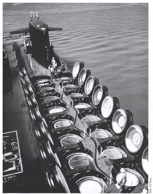
Diese Aufnahme aus den 60er-Jahren zeigt die USS «Sam Rayburn» (SSBN-635) der «Lafayette»-Klasse mit ihren 16 geöffneten Raketensilos für «Polaris»-Raketen.
