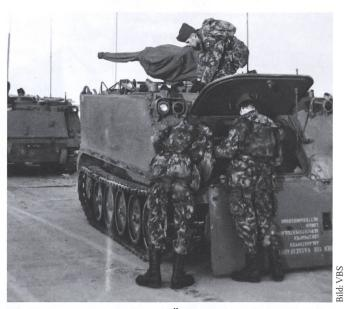
Die OS-Aspiraten 1970 bei der Ölstandskontrolle am M 113. Zum damaligen Zeitpunkt trug der Schützenpanzer noch das schwere M2-Maschinengewehr, das hier zum Transport abgedeckt ist.
