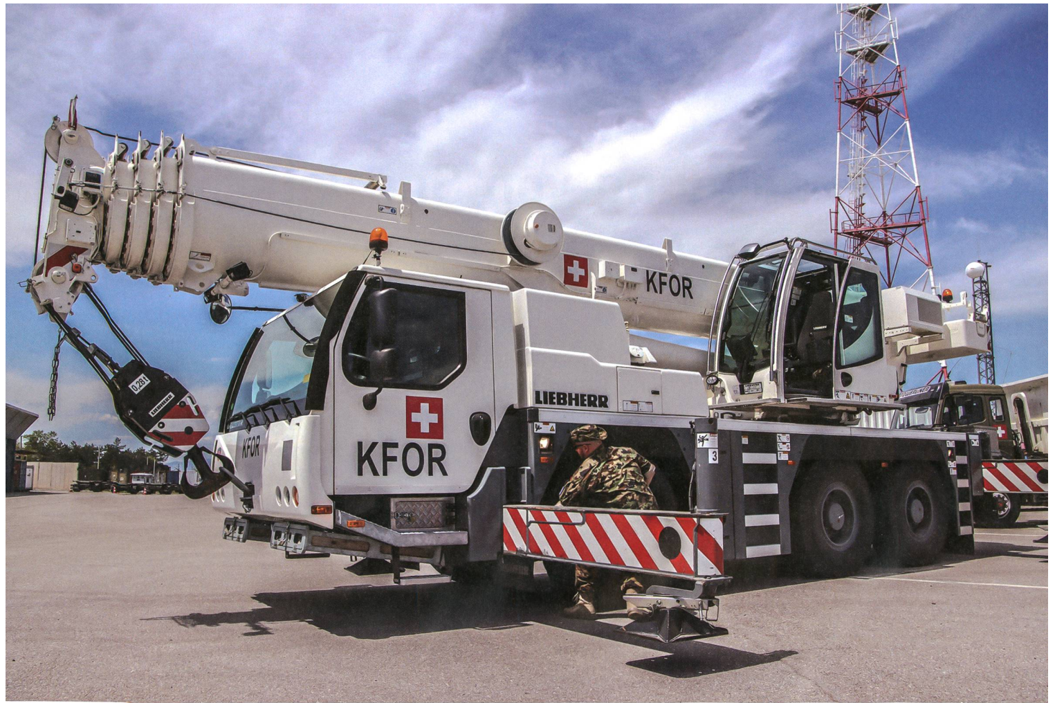
Das Maximalgewicht, das der Kran heben kann, beträgt 55 Tonnen bei einer Ausladung von 2,5 Metern.
