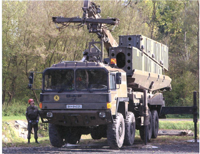
Mit dem Pionierbrückensystem 2000 können innert kurzer Zeit bis zu 40 m lange Pionierbrücken eingebaut werden.
