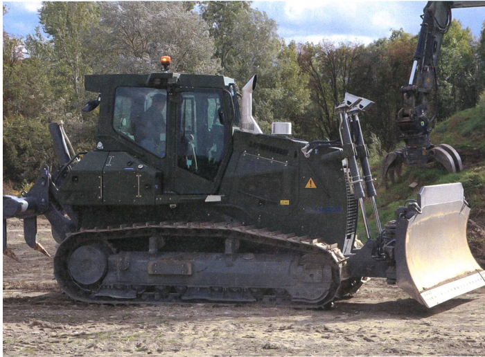
Neuste Anschaffung: Die Planierraupe LIEBHERR PR726 wird für den Strassen- und Panzersperrenbau eingesetzt.
