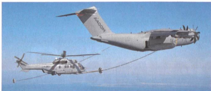
Luftbetankungsversuch der A400M mit einem Helikopter.
