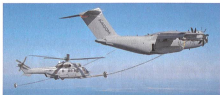
Luftbetankungsversuch der A400M mit einem Helikopter.
