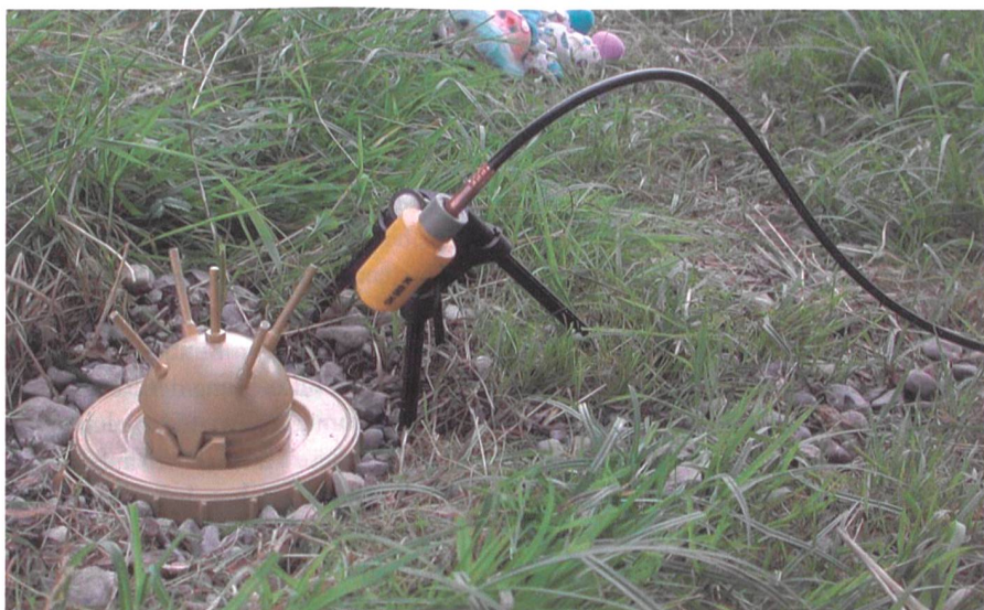
Ziel: Zünder vom Sprengstoff zu trennen.
