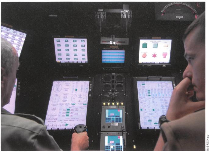
Im Control Room ist fast alles digitalisiert. Die Seiten- und Tiefensteuerung sowie das Rollen werden elektronisch überwacht.
