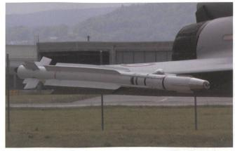
MICA-Luft/Luft-Raketen mit IR-Suchkopf am Flügelende.
