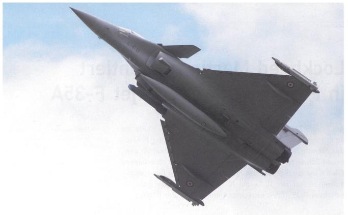
Der Rafale 4-FU mit einem 1250-lt-Zusatztank (Mitte), 2 MICA-Luft/Luft-Raketen mit IR-Suchkopf an den Flügeln und einem Sniper-Targeting-POD links vom Zusatztank. Das prachtvolle Bild gelang dem Fotografen Franz Knuchel.
