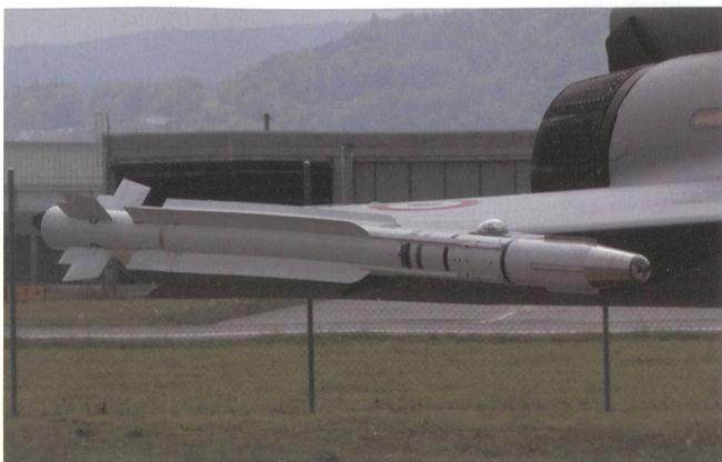
MICA-Luft/Luft-Raketen mit IR-Suchkopf am Flügelende.
