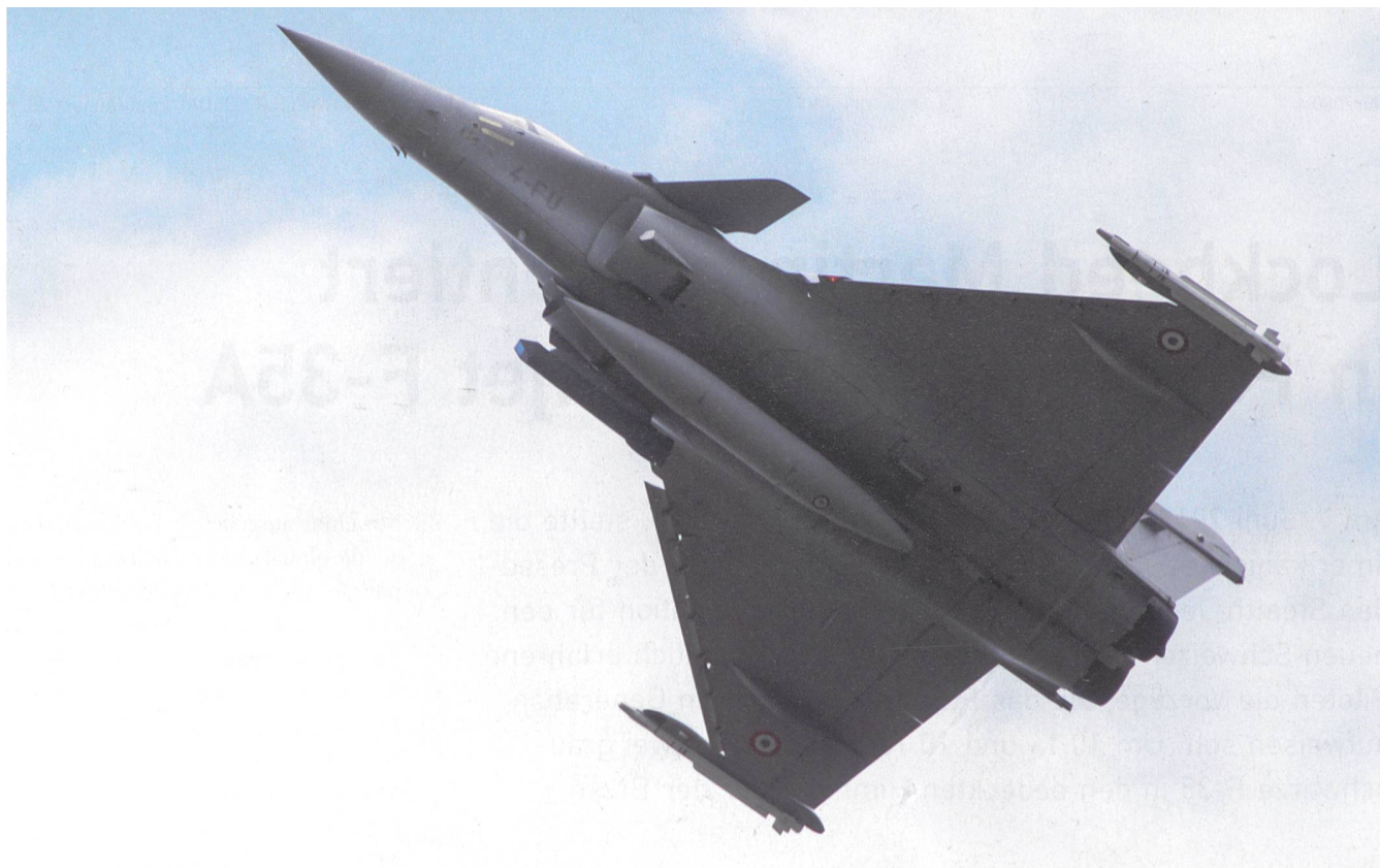
Der Rafale 4-FU mit einem 1250-lt-Zusatztank (Mitte), 2 MICA-Luft/Luft-Raketen mit IR-Suchkopf an den Flügeln und einem Sniper-Targeting-POD links vom Zusatztank. Das prachttvolle Bild gelang dem Fotografen Franz Knuchel.
