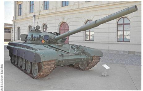
Dresden: Ein gut erhaltener T-72-Tank der NVA mit der 125-mm-Glattrohrkanone. gebaut von Uralwagonsawod.
